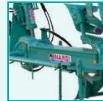
Bure scatolata per spostamento a parallelogramma Box beam for parallelogram displacement Age caissonné pour déplacement à parallélogramme
