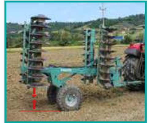
Elevata luce al trasporto Extremely underbeam clearance transport Elevé hauteur sous age pour le transport Luz-libre elevada para el transporte.
