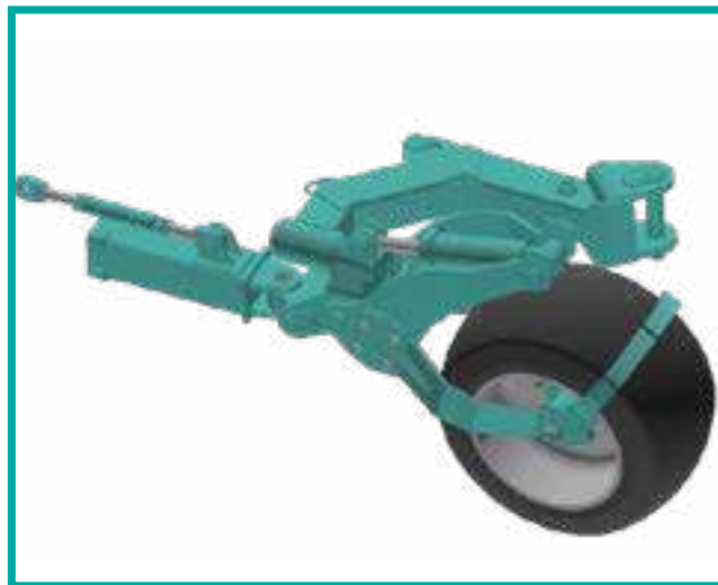
Ruota di profondità e trasporto, cilindro con memoria per la regolazione della profondità di lavoro direttamente dalla trattrice mediante un distributore oleodinamico. Depth and transport wheel and cylinder with position control to adjust the working depth directly from the tractor seat by means of oil-dynamic distributor.
